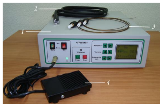
Рис. 2. Внешний вид прибора «Уролит»: 1 — прибор; 2 — передающий кабель; 3 — зонды; 4 — педаль управления
