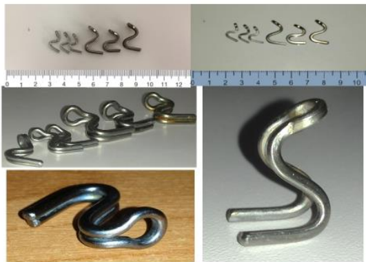
Рис.1 Клипсы из никелида титана.
