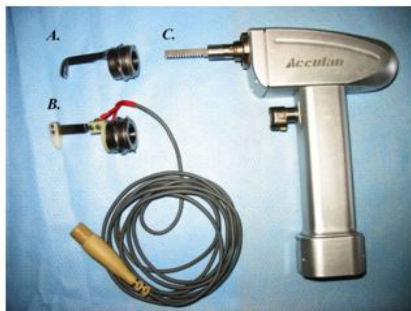
Рисунок 1. Вид холодноплазменного стернотома в статичном положении: А. Стандартный наконечник; В. Холодноплазменный наконечник; С. Электромеханический стернотом.
