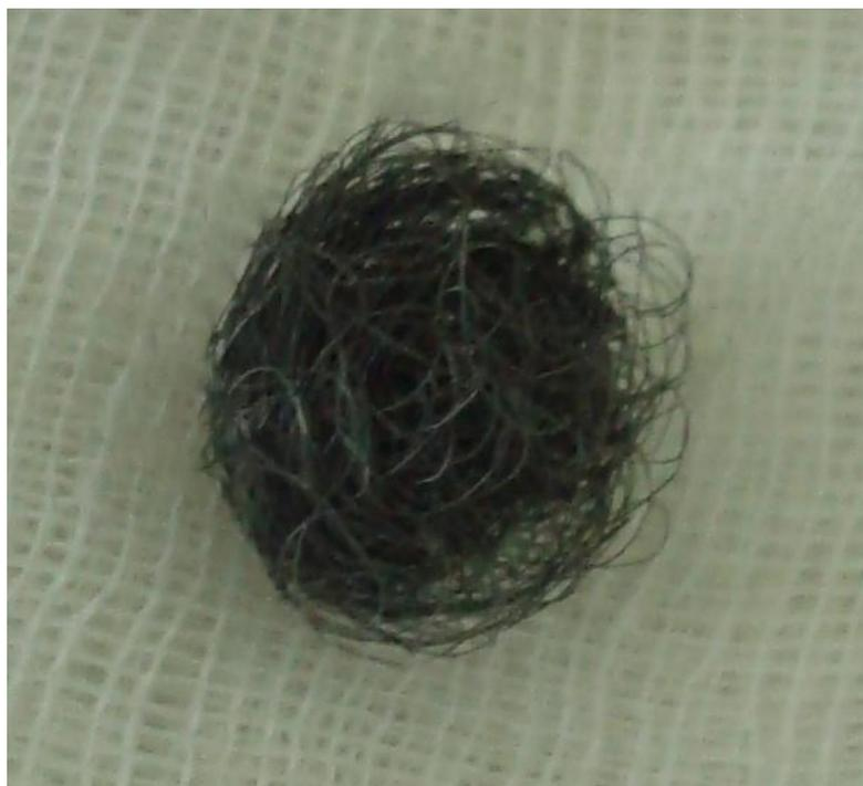
Рисунок 2 – Внешний вид внутриглазного имплантата из никелида титана
