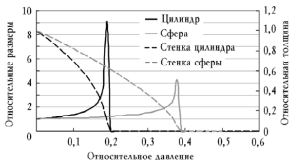
Рис. 3. Зависимость относительного внешнего диаметра \beta и относительной толщины стенок \eta от относительного давления \gamma для цилиндра и сферы
